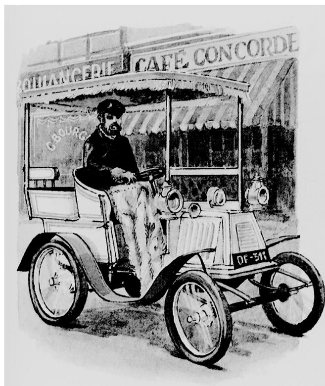
**Voiture Renault en 1901 : puissance un cheval 3/4 pour une cylindrée de 273 cm<sup>3</sup>, avec radiateur d'eau placé derrière le moteur, signe distinctif de la marque.**
