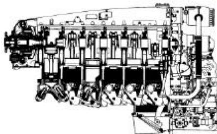
**Moteur Renault-SNECMA 12 S de 580 ch monté dans les Dassault MD-311 à 316 « Flamant ».**
